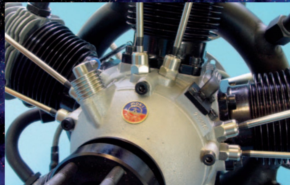
Ansprechende Kurbelgehäuseoberflächen; in der 11-Uhr-Position sitzt die Entlüftung des Kurbelgehäuses nebst Pumpe für die Kraftstoffmembrane
