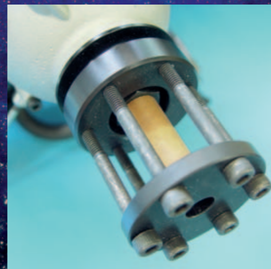
Sichere Luftschraubensicherung mit sechs langen M5-Schrauben
