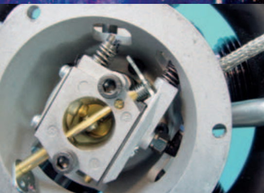
Der Vergaser sitzt im Heckflansch, die Bohrung der Choke-Klappe ist zugelötet
