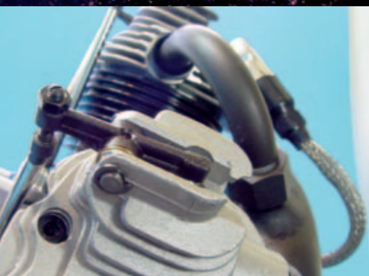
Regelmäßig ist der offen laufende Ventiltrieb mit ein paar Tropfen dickem Schmieröl zu versorgen
