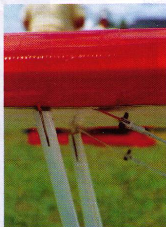
Diese beiden Bilder vermitteln einen guten Eindruck von den sauber eingearbeiteten Flächenverspannungen.
