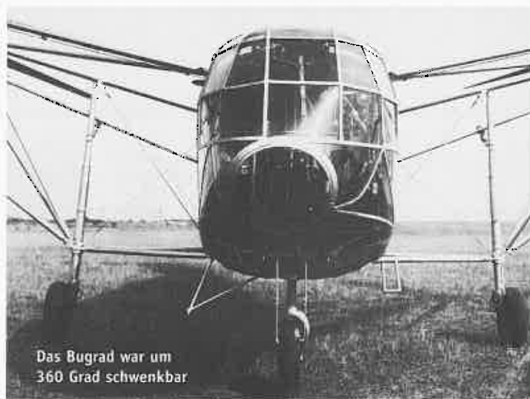
Die Fa 223 V1 mit der ersten Kanzelausführung und schmalerem Heck
