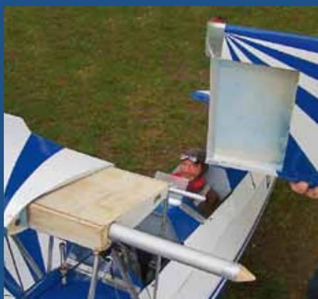
Praktisch und genial: Das feststehende Baldachin-Mittelteil der oberen Tragfläche wird beim Stecken der beiden Flächenhälften verdeckt.
