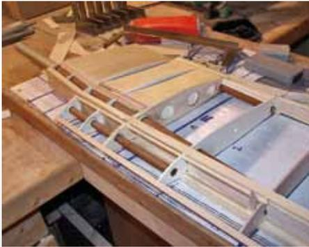
Aufbau der oberen Tragfläche mit Steckung und festem Baldachinmittelteil.
