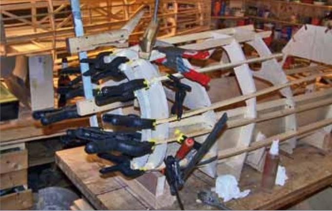
◀ Die Abachigurte wurden vorn ca. 20 cm längs geschlitzt, gewässert und dann auf die Spanten gezogen und verleimt.
