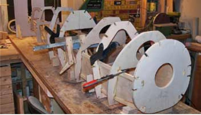
◀ Die Spanten werden auf die innere Helling aufgefädelt, ausgerichtet und verleimt.
