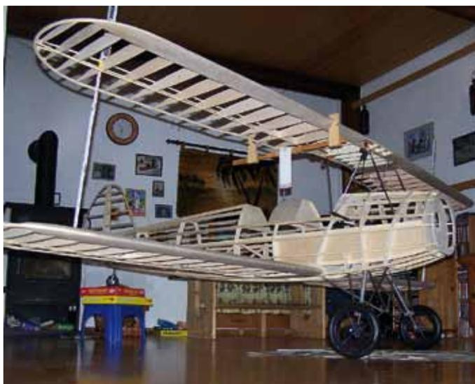
Beim Ausrichten der oberen Tragfläche sind Zollstock, Wasserwaage, EWD-Waage und natürlich viel Augenmaß gefragt.
