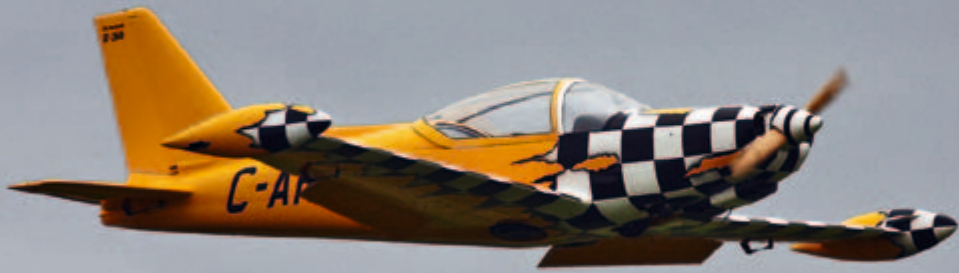
Die neue CARF-SIAI Marchetti SF-260 (Voll GFK, 2,83 m Spw., 15-16 kg, 60-120 cm 3 ) ist mit einem Moki 100 cm 3 4-Takter ausgerüstet. Das Modell ist auch als Turboprop-version lieferbar. CARF, Tel.: 06151 9179156, www.carf-models.com
