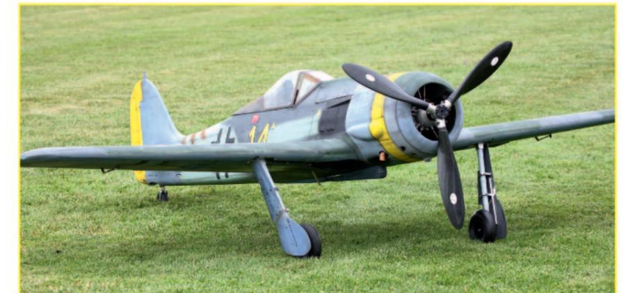
Die Fw 190 F8 von Roland Fuchs ist mit einem 215-ccm-Moki und dem im Text beschriebenen Verstellpropeller ausgerüstet. Damit zeigte das Modell sehr gute Flugleistungen. Daten: Maßstab 1:4, Spannweite 267 cm, Gewicht 22,5 kg.
