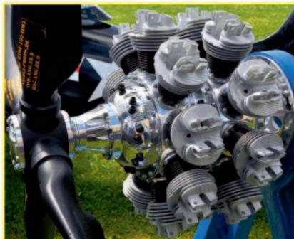
Der absolute Blickfang auf dem Heilemann-Stand war der neue, noch nicht lauffähige 18-Zylinder-Doppelstern mit einem Hubraum von 700 ccm und einer Getriebeübersetzung von 1:1,6! Auf dem Bild ist er bereits probeweise auf der großen F8F Bearcat von OFB Ostermeier Flugzeugbau montiert. In Abstimmung mit den von Heilemann vorgegebenen Motordaten entwickelte Seidel-Props einen Vierblatt-Verstellpropeller mit einem Durchmesser von riesigen 49 Zoll – das sind immerhin knapp 1,25 Meter!
