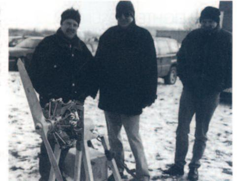
und seinen Lauf betrifft, alle Versuche abgeschlossen – es steht nur noch der Zugtest mit unterschiedlichen Luftschrauben an. Ganz vorsichtig kann ich schon einmal 15 kp Schub mit einer 32x12 vermeiden (bei den oben angegebenen Höchstdrehzahlen).
