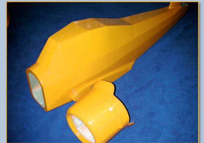
▲ ▼ Der Bausatz umfasst in der Voll-Ausbaustufe (d.h. einschließlich Vorflügel für die Tragflächen und die vier Landeklappen) immerhin 15 GfK-Teile! Die markant strukturierte Oberfläche der Bauteile (inkl. aller Sicken, Blechstöße, Nieten und Anformungen) ist bereits in der Form lackiert und bedarf bei sauberer Bauausführung kaum einer weiteren Farbbehandlung, vom entsprechenden Wunsch-Design einmal abgesehen. Die Serien-Farbe ist Gelb, andere Einfärbungen sind auf Wunsch möglich.
