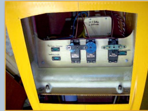
◀ Der Hauptzugang zum Rumpf erfolgt über die Unterseite. Die Aufnahme für das Steckrohr ist bereits werkseitig montiert. So muss lediglich ein Sperrholzbrett für die Montage der Höhen- und Seitenruderservos eingeleimt werden. Hier ein Blick in das Innenleben von Stefan Thiels Z-37A. Die beiden sichtbaren Druckluftanschlüsse sind jetzt Dummies, da Stefan die Landklappen auf Servos umgebaut hat.
