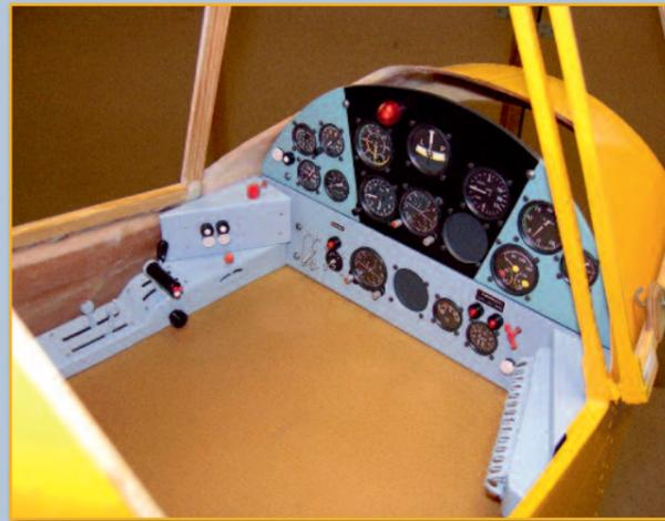
◀ Der gartenstuhllähnliche Original-Pilotsitz wurde von Stefan Thiel hervorragend nachgebaut. Der Raum unter dem Armaturenbrett ist bei seiner Cmelak durch ein Alublech komplett geschlossen. Bei der Maschine des Autors kann man an den Beinen des Piloten vorbei den Tankinhalt kontrollieren.
