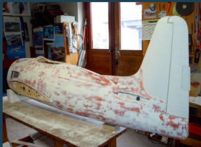
Schleifen und Füllern sind nun die sich mehrfach wiederholenden Prozeduren (Bild links).
