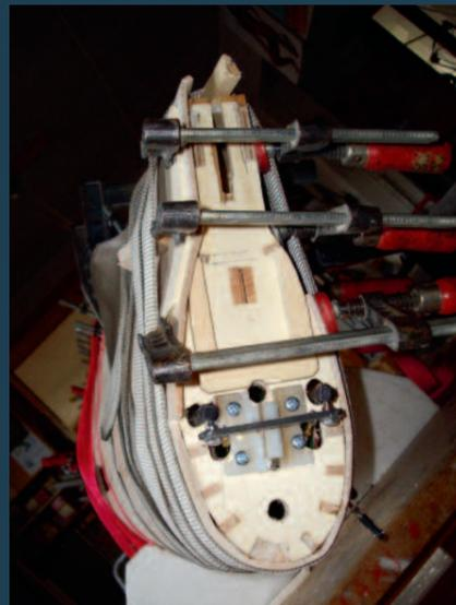
Das Rumpheck ist fertig beplankt – Schraubzwingen und Spanngurte halten bis zum Durchtrocknen der Verklebung alles an Ort und Stelle,
