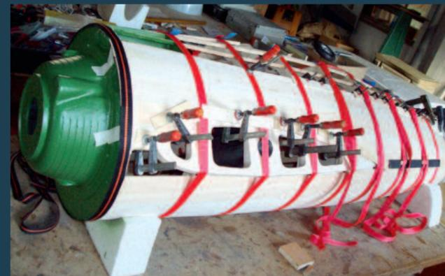
Hier noch einmal ein Rückblick auf die Bauphase, speziell auf den Motorträger am fast fertig beplankten Rumpf ...
