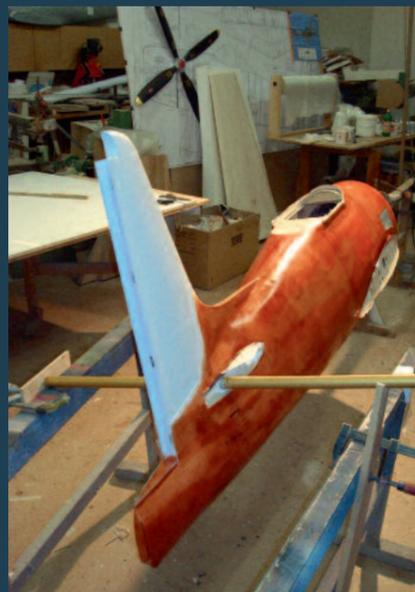
Hier hat der Rumpf seine GfK-Schicht erhalten. – Im Bild links sind die Trimmruder in Seiten- und Höhenruder ein markantes Detail.
