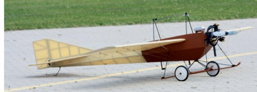
▲ Zum 100. Geburtstag: 1:4-Modell der Vickers 1910 des Autors; Antrieb Saito 170-R3. Der Keleo-Ringschalldämpfer sorgt für einen kernigen Sound, die zusammen knapp 28 ccm Hubraum der drei Zylinder stemmen genügend Kraft auf den Propeller, um das 2,5 Meter spannende Modell mit Flächenverwindung angemessen durch die Lüfte zu bewegen.
