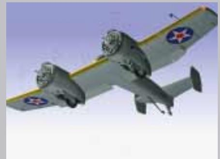
Die beiden wuchtigen Motorhauben dominieren die Ansicht von vorne bzw. schräg vorne. Um die Maschine mit akzeptablen Landegeschwindigkeiten für den Einsatz auf Flugzeugträgern auszustatten, erhielten sie Landeklappen vom Rumpfansatz bis zu den Querrudern
