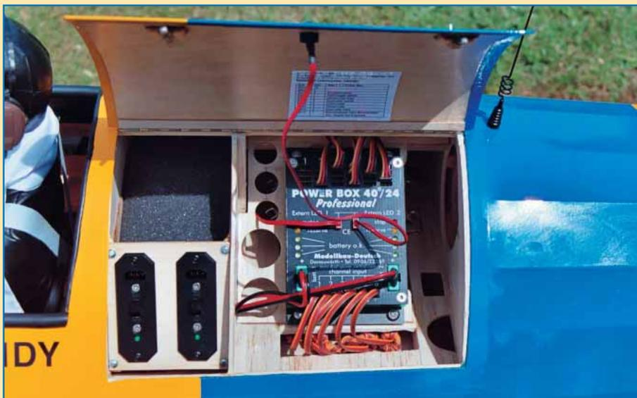
Hinter dem Cockpit befindet sich die Stauraumklappe, darunter die beiden Schalter und die Powerbox-Akkuweiche
