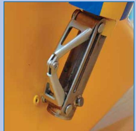
Wer A sagt, muss auch B sagen: die Federung an einem der beiden Fahrwerksbeine
