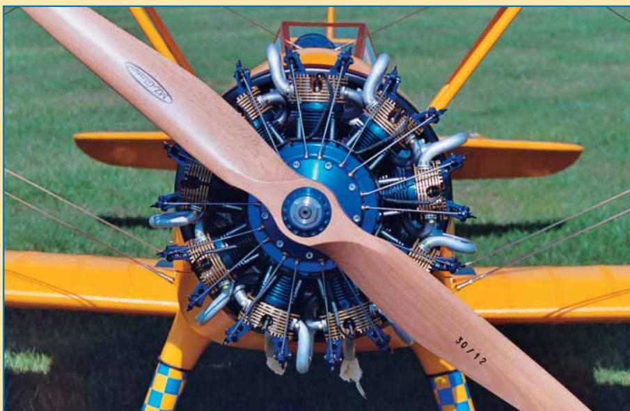
Das ist er, der Eigenbau-Sternmotor, dessen Bau uns fünf Jahre „gekostet“ hat. Er dreht eine  $30 \times 10^3$  mit  $5000 \text{ min}^{-1}$
