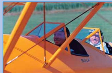
*Spanndrähte sind im Baukasten enthalten, allerdings aus Rundmaterial. Ich konnte es mir nicht verkneifen, sie durch profilierte aus Edelstahl zu ersetzen*
